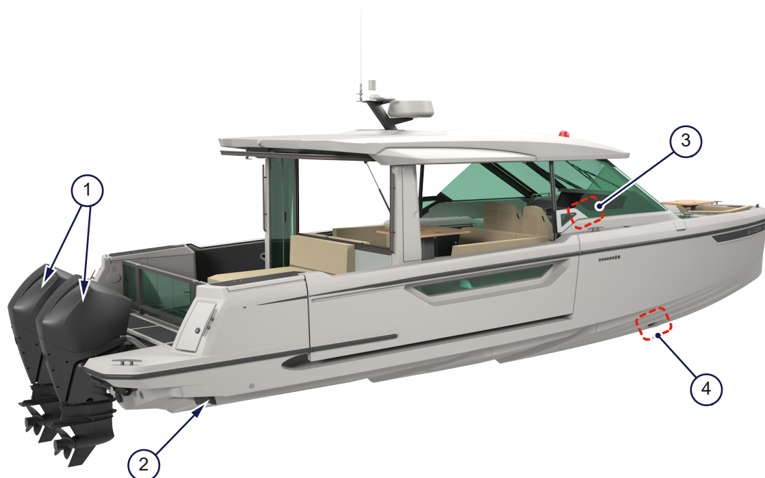
Figur 5.5 - Motor och styrning
